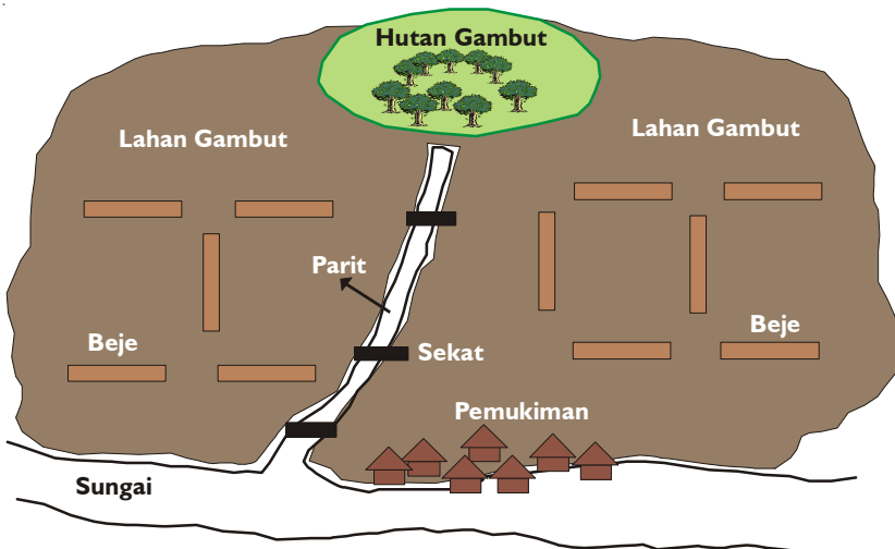
Gambar 29. Sketsa penempatan beje dan sekat parit sebagai media budidaya ikan dan sekat bakar
